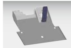
Un diseño de dos piezas hace que el piso sea fácil de levantar y maniobrar. Remover la pieza trasera del piso permite un amplio acceso al motor y al tren de tracción.
