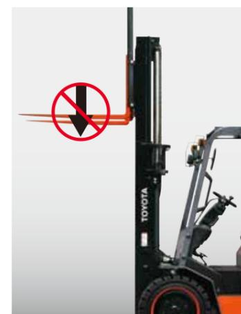
Una vez apagado las horquillas no descenden aunque se operen las palancas de manejo de carga. Esta función puede ayudar a prevenir accidentes causados por una operación involuntaria llevada a cabo por otra persona ajena al operador.
