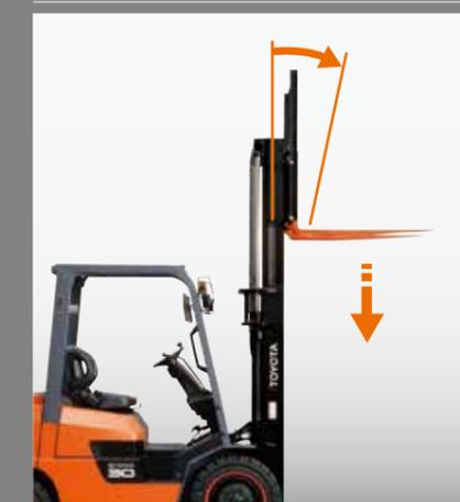
Una válvula de verificación en la válvula de control reduce la posibilidad de descenso espontáneo de las horquillas y la inclinación hacia delante. Esta función se instala cuando se ha seleccionado el sistema OPS.
