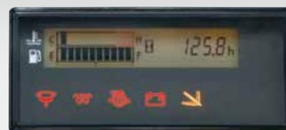
Este medidor combinado incluye el indicador de temperatura de agua, medidor de combustible, contador de horas, alarma de temperatura de aceite del motor y otros indicadores, lo cual facilita la verificación del estado del montacargas.
