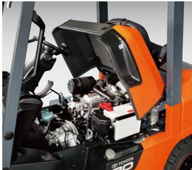
La cubierta de motor de amplia apertura permite un fácil acceso al motor durante una inspección o servicio.
